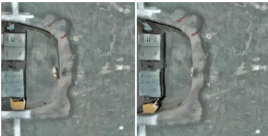
Abb. 8: Abgewickelte Tunneloberfläche dargestellt in orthographischer (links) und perspektivischer (rechts) Projektion
